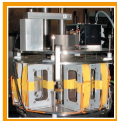
Le schede di acquisizione e di controllo presenti nel PC consentono la generazione e la lettura di tutti i segnali di interesse con 16 bit di risoluzione. Il software a corredo consente l'esecuzione delle prove di colonna risonante e di torsione ciclica, nonché le operazioni di consolidazione del provino.
